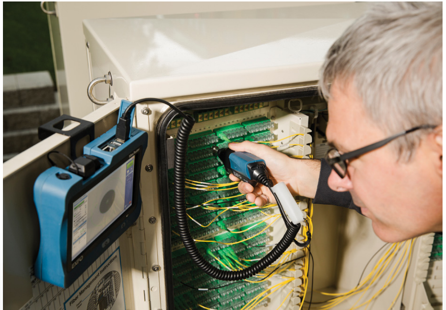
Einsatz des optionalen GP-2176-Hakens für die MAX-FIP
