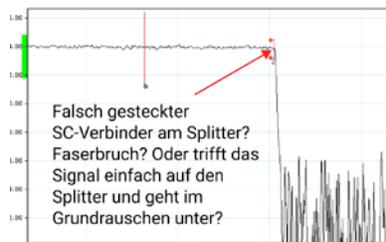
Abbildung 2: OTDR-Kurve für den Anschlussbereich
